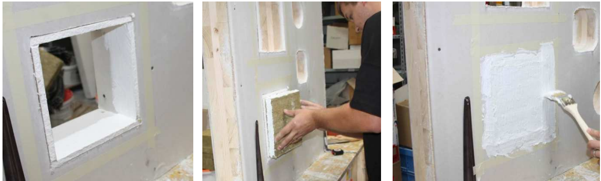
Abbildung 83: Einbau des Weichschotts in einen Probekörper (links: Leibungsverkleidung Mitte: Einbau der an den Kanten beschichteten Mineralfaserplatte, rechts: Überbeschichtung der Oberfläche über den Rand von 20 mm)
