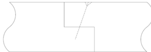
Abbildung 59: Restholzquerschnitt im Bereich der Fuge bei Stufenfalzverbindung
