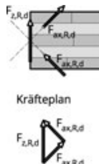
Abbildung 4.16 Widerstände des Schraubenkreuzes bei vertikaler Last
